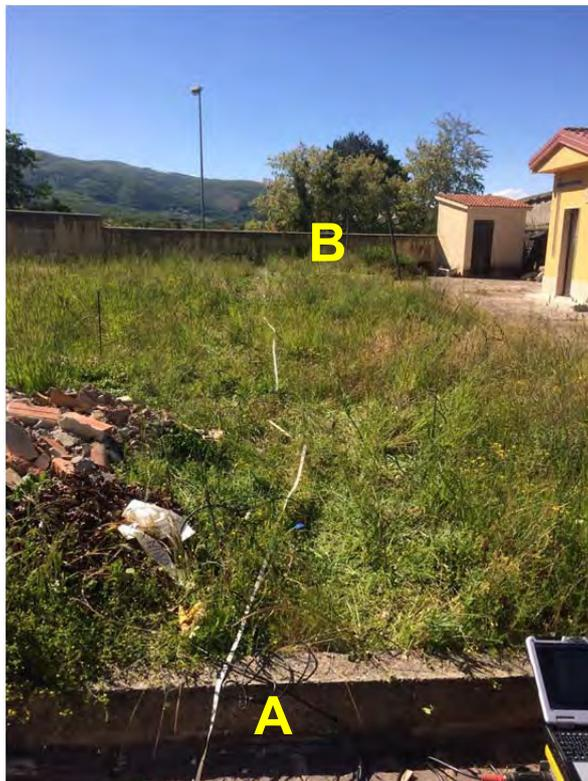
**Foto 1.** Prospezione sismica a rifrazione ad onde P
